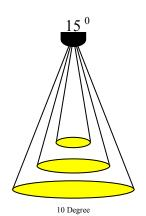
Light Dimansion Parameters  $1m/\varnothing$  : 0,26 m  $2m\,/\,\text{\o}$  : 0,52 m $3m / \emptyset$ : 1,10 m
