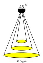
Light Dimansion Parameters  $1\,m\,/\,\text{Ø}$  : 0,80 m $2m / \emptyset$  : 1,60 m  $3m / \emptyset$ : 2,40 m
